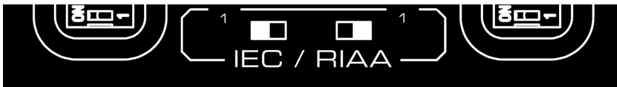
Рис.5: Микропереключатели выравнивания кривых для левого и правого каналов.
