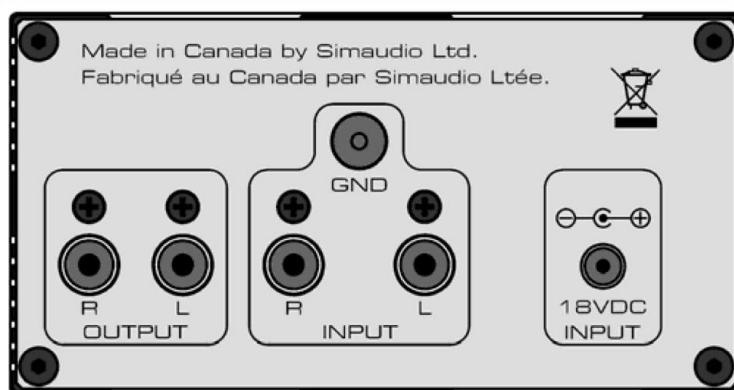
Рисунок 6 : Задняя панель фоно предусилителя “Moon 110LP”.
