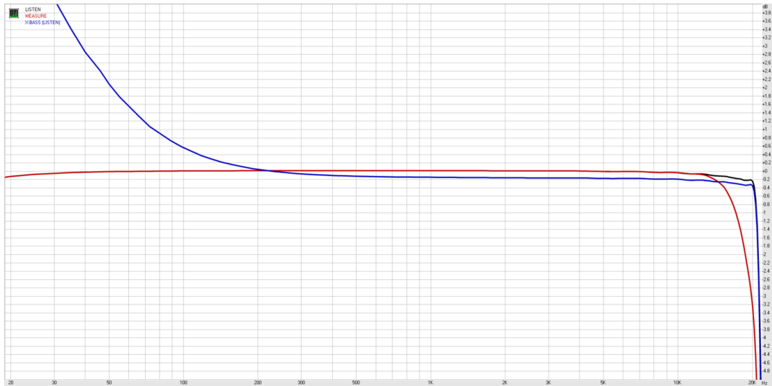
Разница АЧХ аудиовыхода в режимах Listen, Measure и 3D (Measure)
